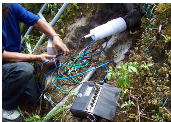
照片 71 100.8.19 汰換翡翠水庫大壩電氣式伸縮儀量測基座
