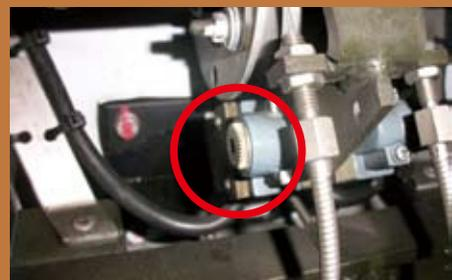
▲圖21 車門微動開關作動桿脫落
