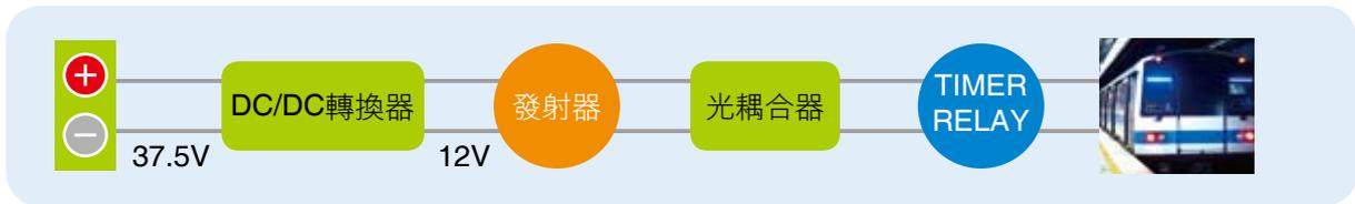
▲圖15 定點偵測發射器/接收器方塊圖
