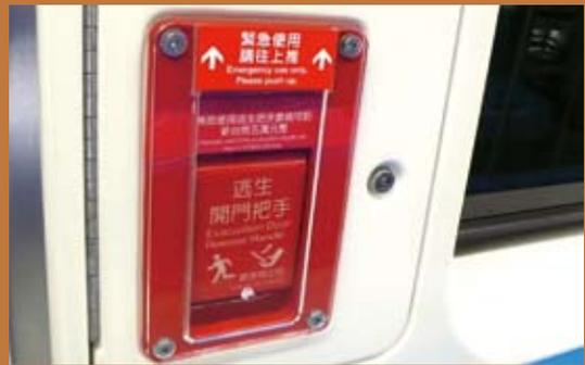
▲圖30 內部手動釋放裝置加設壓克力護蓋
