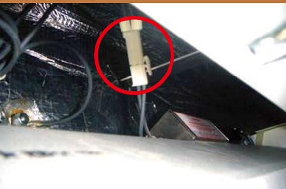
▲圖26 電源轉換器電纜加裝快速拆裝接頭
