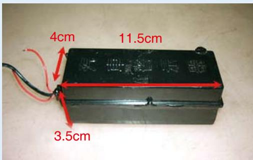
▲圖17 發射器實體尺寸圖
