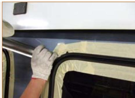
▲圖13 車側玻璃窗膠條間隙填縫
