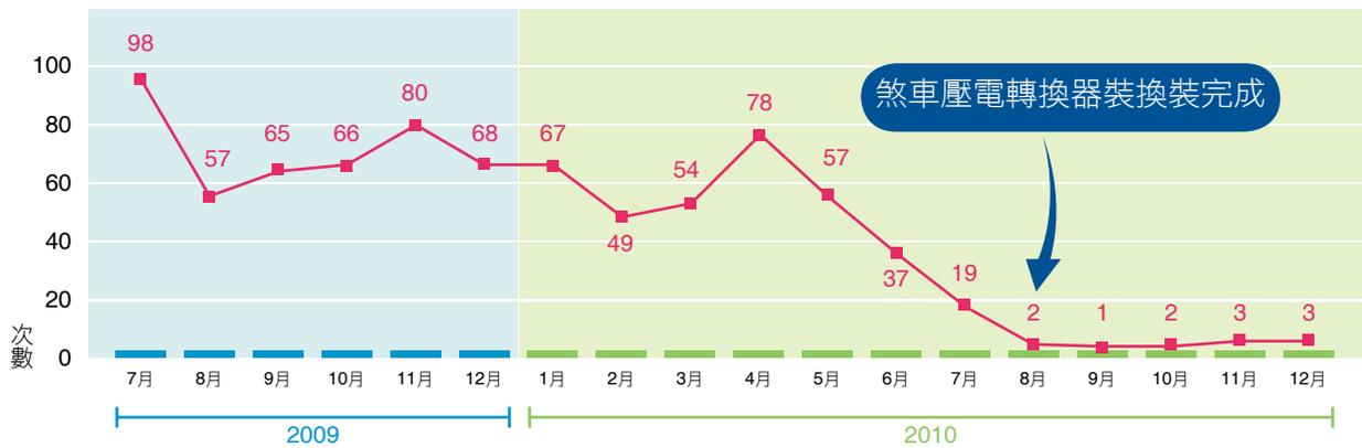
▲圖24 煞車壓力偵測元件故障趨勢圖
