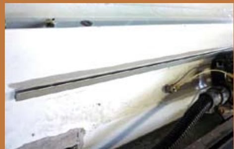
▲圖10 U型鋁製導水槽
