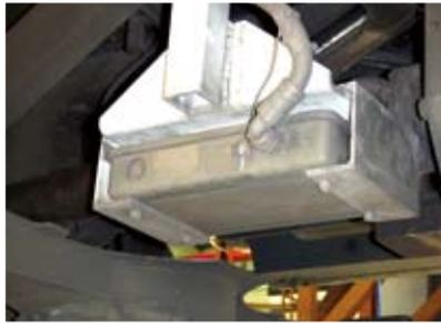
▲圖14 車載基準點讀取器
