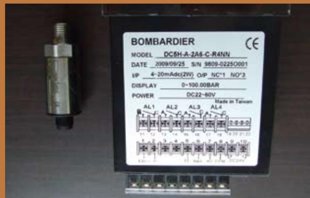
▲圖23 數位煞車控制面板與煞車壓電轉換器
