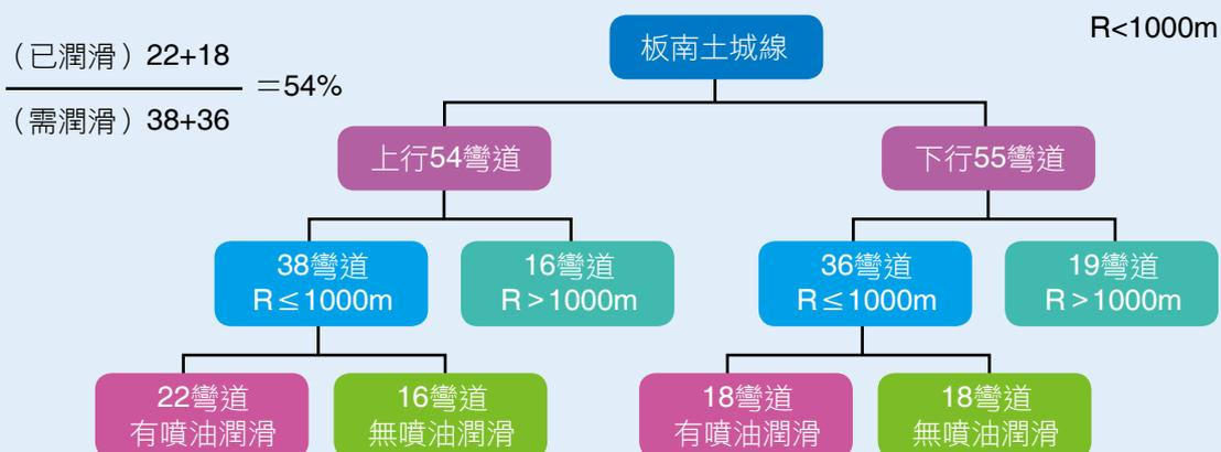
▲圖11 計時式於彎道噴油潤滑比例
