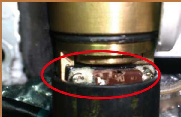
▲圖22 煞車壓力微動開關
