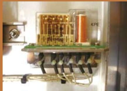
▲圖17 改善後電路板焊接電驛與電纜端子
