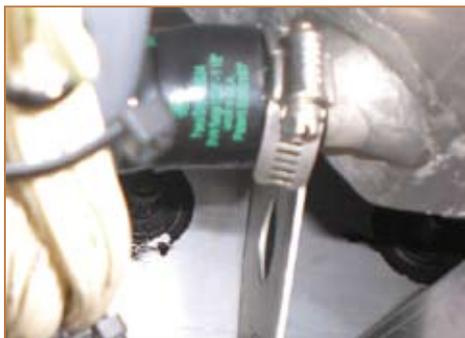
▲圖11 車頂排水管路接頭水密固定
