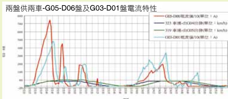
圖12 2盤直流盤供給2部車用電電流特性
