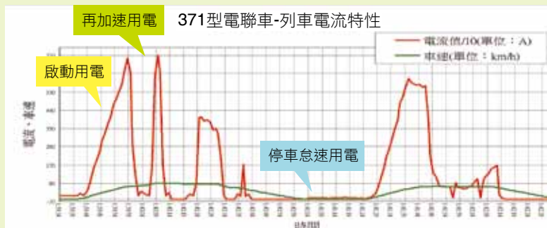
圖2 371型電聯車-列車電流特性
