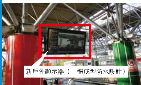
▲圖8 戶外顯示器防水設計差異
