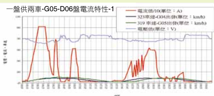
圖6 1盤直流盤供給2部車用電電流特性
