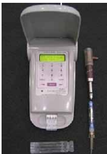
圖 4、LOCAD-PTS：移動式單晶片應用與檢測系統。圖像來源：NASA。
