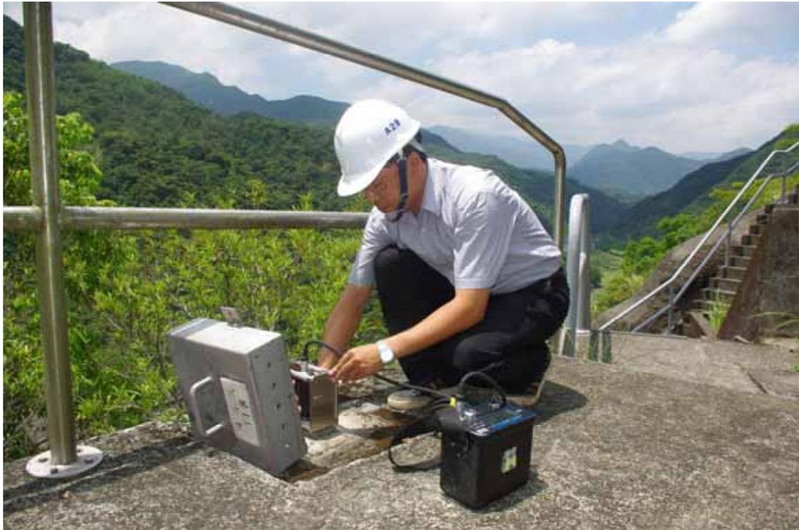
安全檢查科人員進行大壩監測儀器現場量測(傾斜儀)
