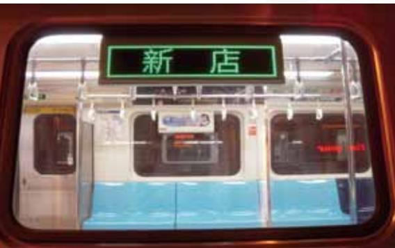
圖6 車側目的地顯示器
