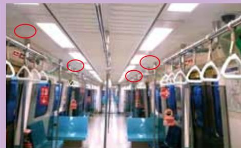
圖3 車廂加裝喇叭使廣播音量均量化
