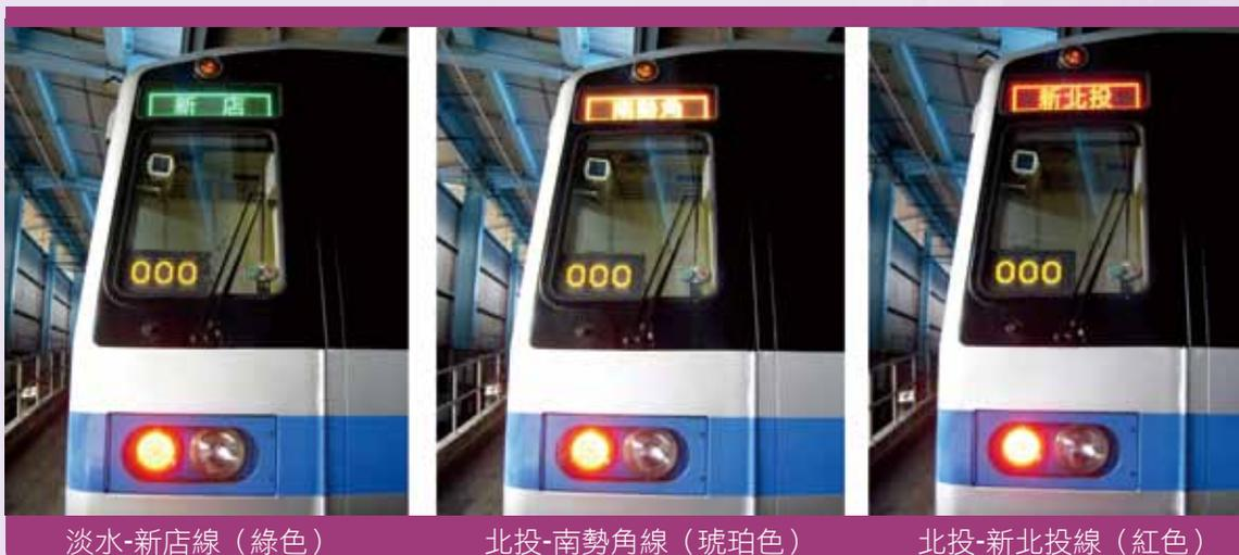
圖10 車頭目的地顯示器各路線顯示方式
