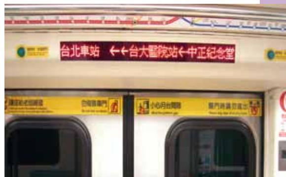
圖5 原到站顯示器最多僅能顯示5個中文字
