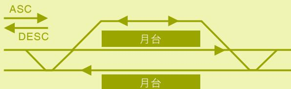
圖5 型III\_L車站軌道佈設
