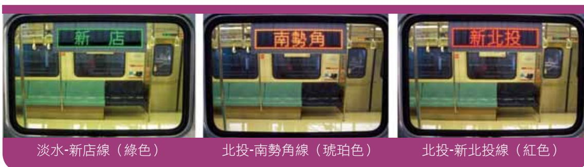
圖11 車側目的地顯示器各路線顯示方式
