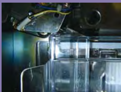
圖24 改善後票卡可正確回收定位
