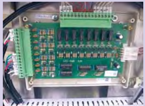
圖10 自行開發介面電路板（8in/8out）
