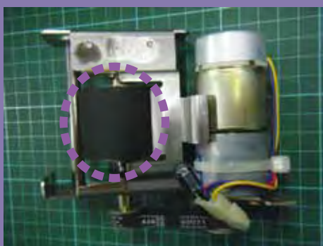
圖23 票卡導軌導片過長部份切割
