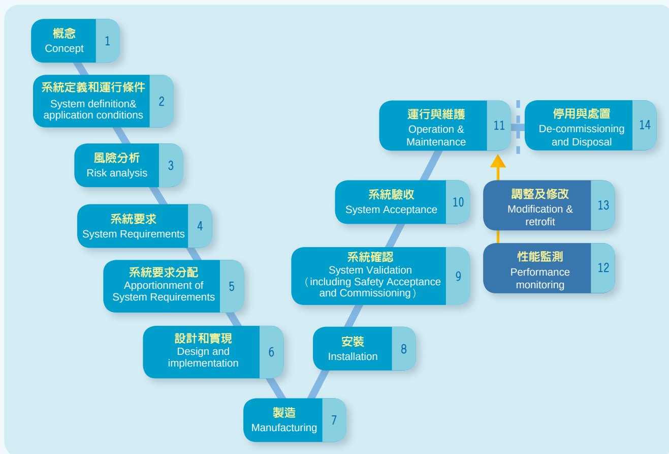
圖5 RAMS工程的V-model (管孟忠, 2011)
