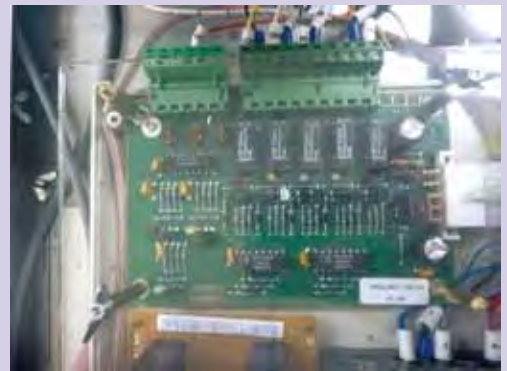
圖9 原廠介面電路板（3in/5out）
