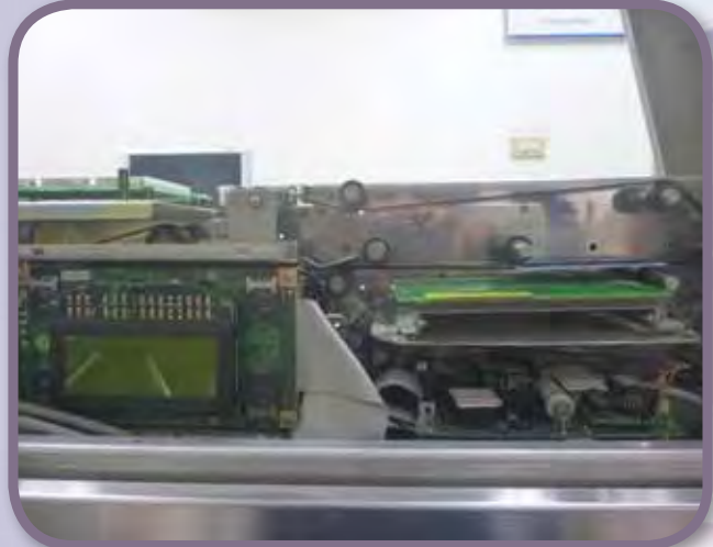
圖29 整合後車票傳送器（側面）
