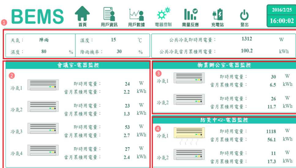
圖 2-3、智慧建築能源管理系統電器控制頁面功能顯示
