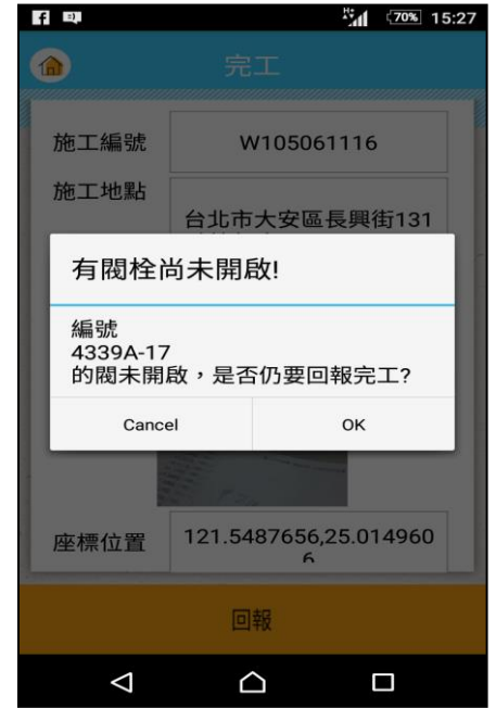
圖 11：完工回報 閘類開啟狀態檢查
