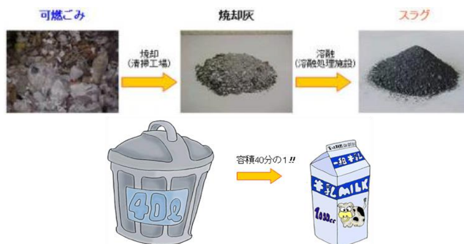
圖 三-20：可燃垃圾焚化處理體積縮減示意圖
