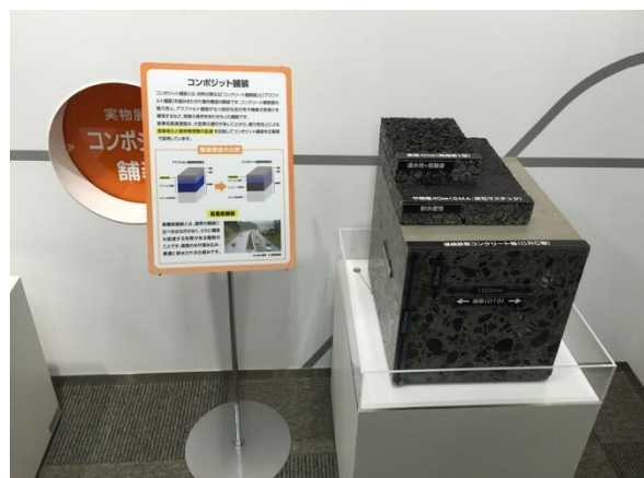
圖 四-3：高速道路的透水鋪面展示，具透水、低噪音功能
