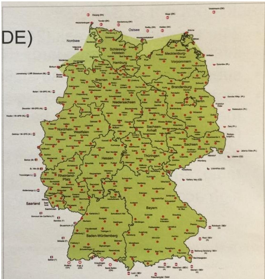
圖 4-8 德國衛星基準站定位系統(SAPOS)基準站分布圖
