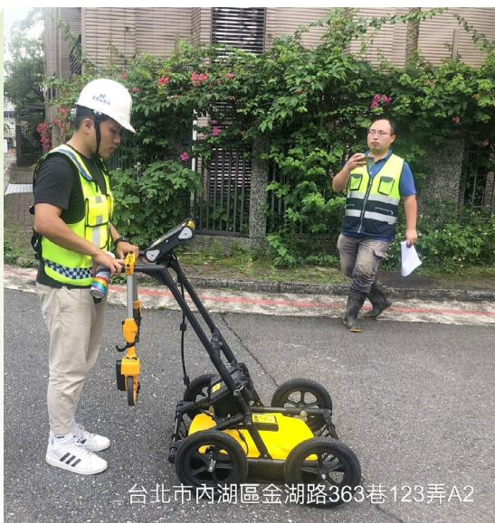
臺北市政府規定，工程在放樣勘驗和竣工前，需針對基地周邊 20 公尺內的道路，進行深度超過 3 公尺的地質探測和高程調查，並將結果送交道路主管機關備查，以作為施工與作為後續道路維護的依據。
