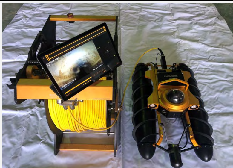
附件圖2：CCTV 及聲納在主、次幹管內檢視實際操作
