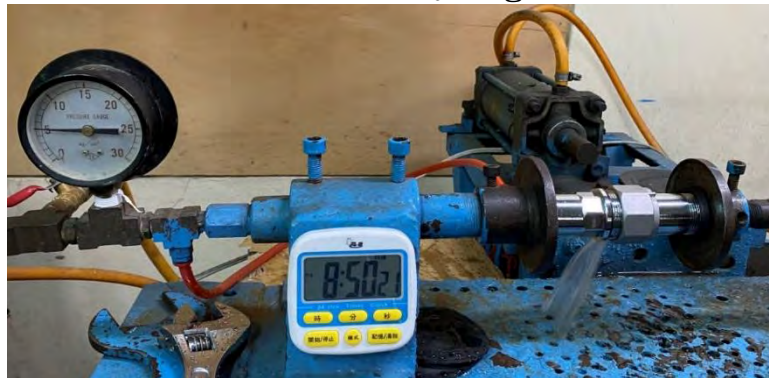
本體排水測試可正常排水
