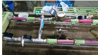
圖3：水表內空氣氣室排除 圖4：水錘吸收器減緩水表自走測試
