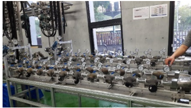
圖3：水表內空氣氣室排除 圖4：水錘吸收器減緩水表自走測試
