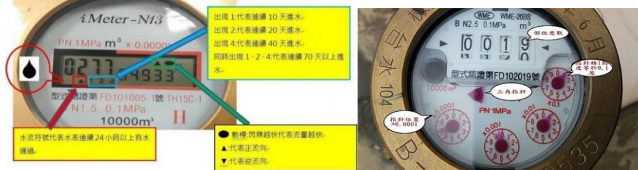
圖5：水錶儀表可用於偵測漏水
