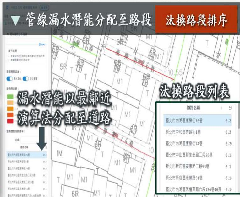
圖 2 漏水潛能進階應用-管汰路段排序分析
