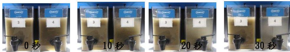
圖 4 原水加注高子沉降情形(#3 原水；#4 原水加注高分子)
