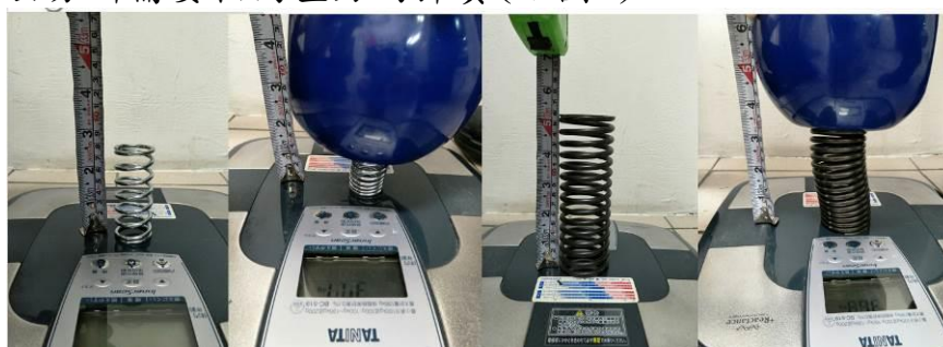
圖3：驗證安妮彈簧與壓胸器彈簧位移5公分所需施力
