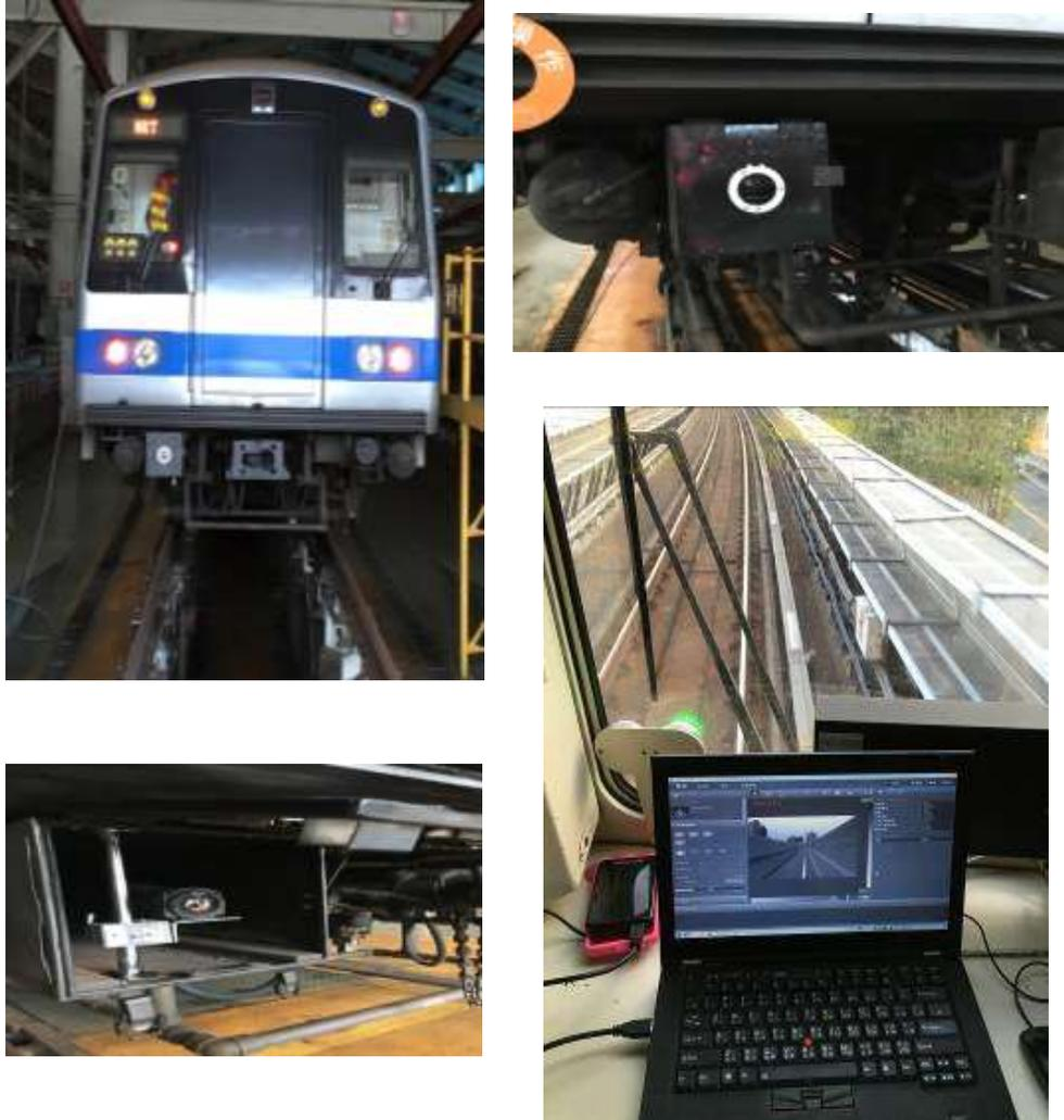
圖3、紅外線熱像儀架設至電聯車
