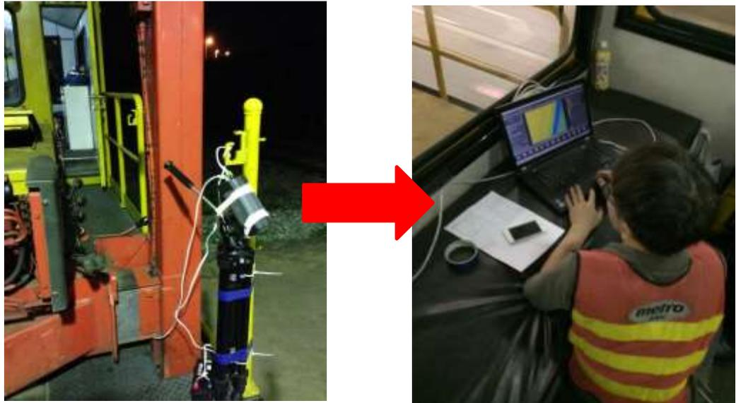
圖1、紅外線熱像儀架設至工程車
