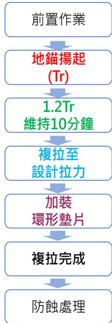
圖5 地錨複拉標準作業程序
