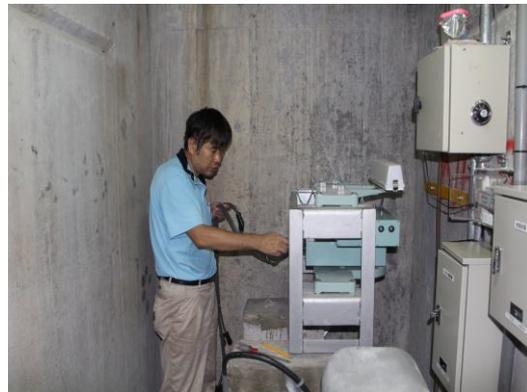
**擺線儀位移偵測設備調校**
