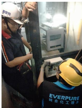
照片 3 擺線儀 NPL3 測站設備汰換 照片 4 擺線儀位移偵測設備調校
