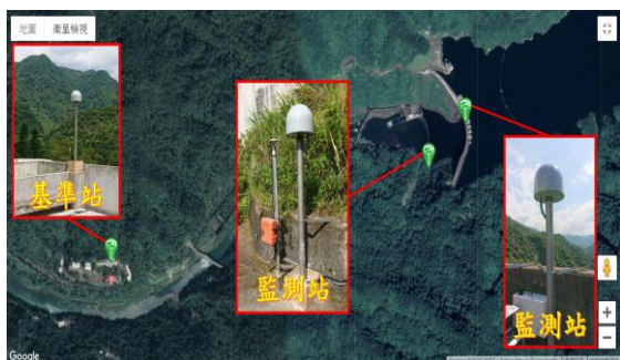
圖 2 新設大壩及左壩座 GNSS 測站
