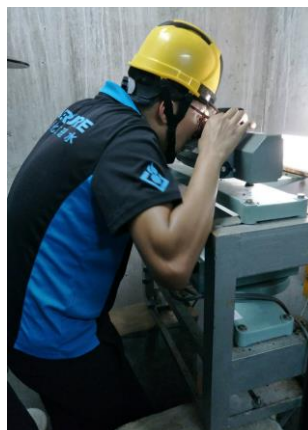
照片 3 擺線儀 NPL3 測站設備汰換 照片 4 擺線儀位移偵測設備調校
