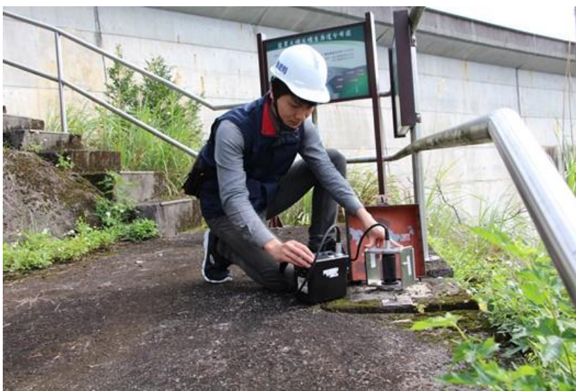
圖 1: 翡翠大壩壩座傾斜儀量測
