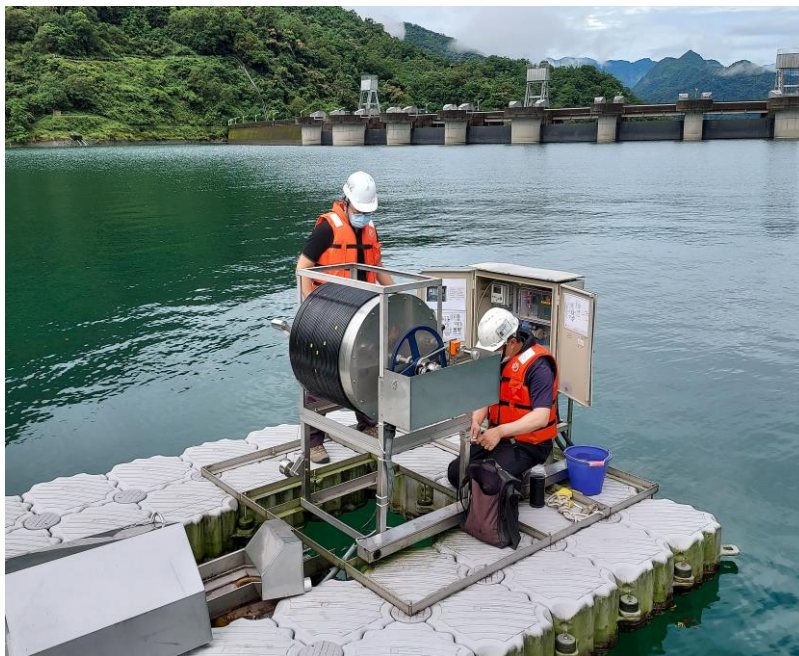
圖 5：翡翠水庫大壩區水質分層自動監測系統汰換
