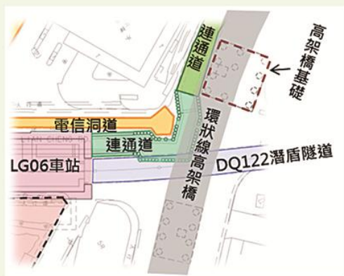
LG06車站與環狀線及電信洞道關係示意圖
