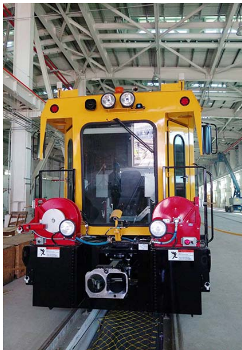
臺中捷運軌道研磨車正面
