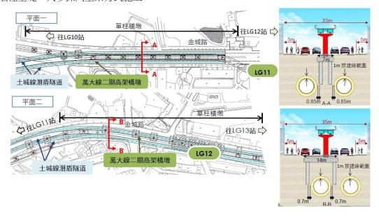
為避免大型門型架橋墩太靠近鄰房引起民眾反彈及佔用路外用地影響街廓開發與使用等問題,配合橋墩結構配置檢討,儘可能採用單柱結構型式,共節省工程經費約5.7億元。
