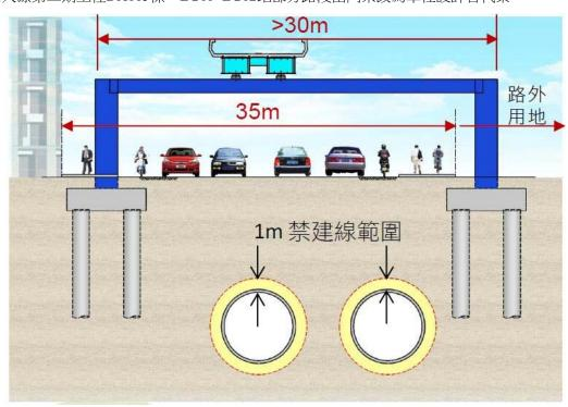
原規劃:因土城線潛盾隧道非沿金城路中央佈設,高架橋梁(含高架車站)部分路段原規劃案無法於潛盾隧 道間佈設墩柱基礎,大多採門型架方式施工。
