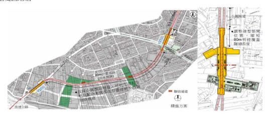
替代案:Y20~Y21站間改採雙小圓潛盾隧道,並於Y21站兩側採≥2m近接施工之方式,另為維持月台於直線段,將Y21站月台中心北移9.5m,共節省工程經費約5.45億元。
