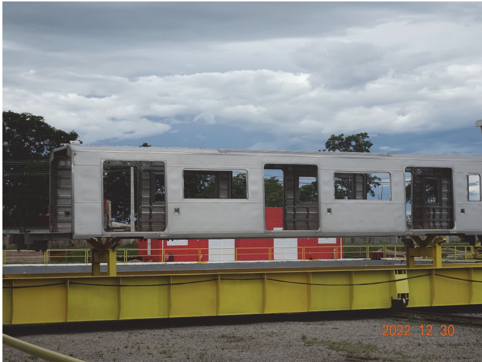
圖3.組立完成之萬大線原型車列車車廂
