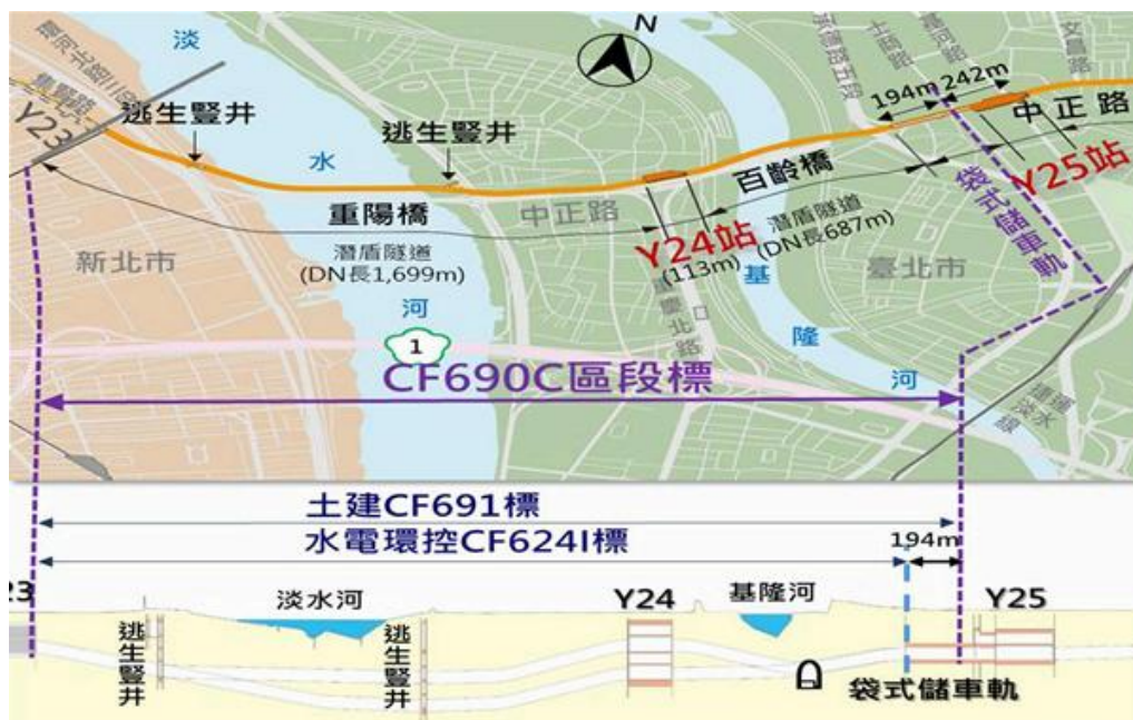
圖1 環狀線北環段CF690C區段標施工範圍示意圖
