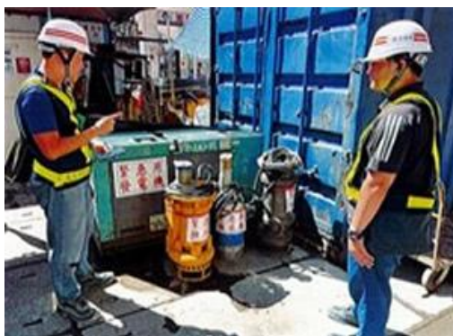
圖1 防汛專用發電機及抽水機等數量清點 及功能測試
