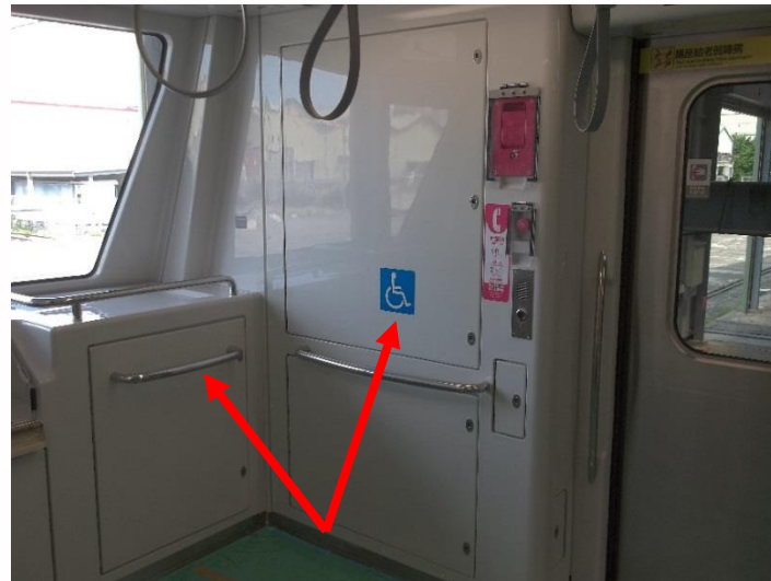
臺中捷運車廂輪椅區扶手及標示
