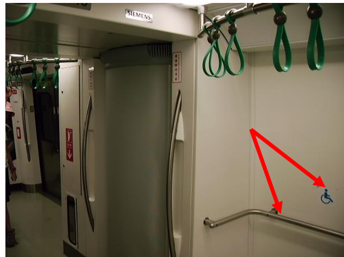
高捷車廂輪椅區標示及扶手
