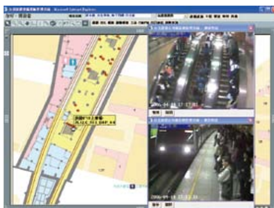
↑ 圖 8・連結即時影像監視設備運轉及車站旅客人潮動態實況
