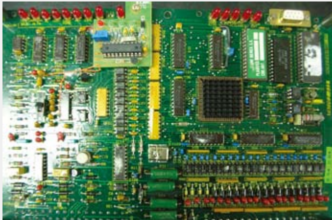
←圖 6・空調電路板安裝空調自動切換重置電路之完成照片
