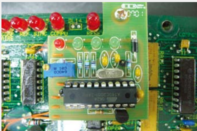
←圖 7・空調自動切換重置電路之完成照片
