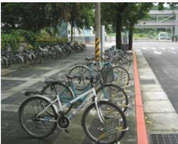
前輪置放式自行車架（適用於人行道設施帶較寬處）
