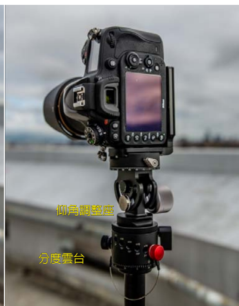
圖15.使用分度雲台與仰角調整座
