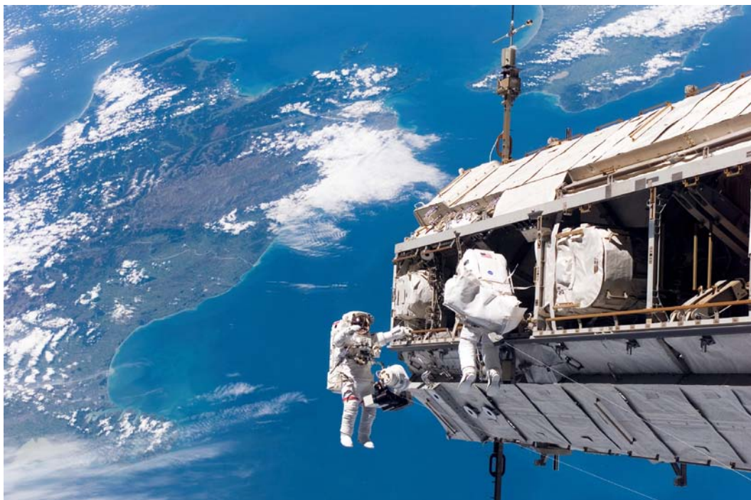
圖4. 2006年，太空人正在安裝桁架，桁架是用來安置太陽能板和艙外機器的結構。圖片來源：wiki
