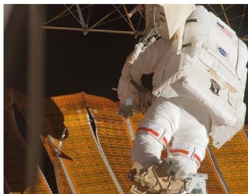
左：太陽能板撕裂處的特寫，中：太空人站在機械臂上靠近損壞處，右：接近撕裂處進行修復。
