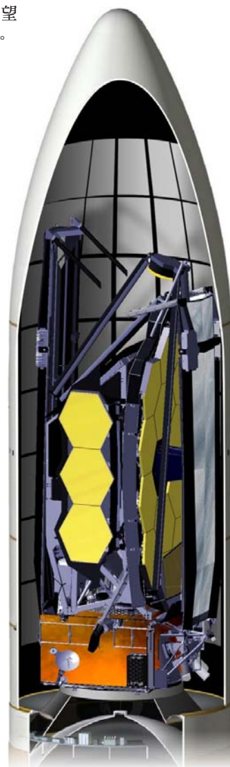
圖2：韋伯望遠鏡折疊後放進亞利安5號火箭。
