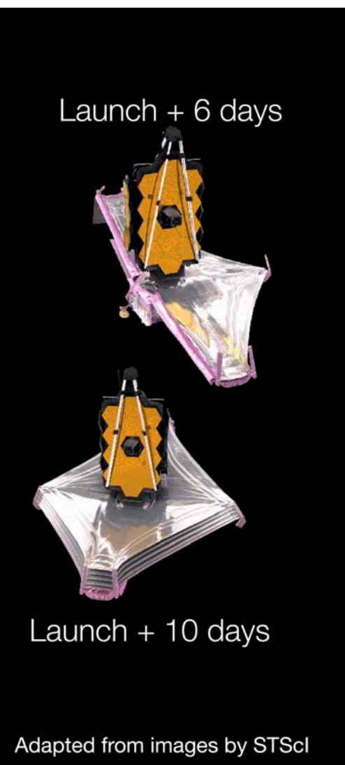
圖3：韋伯望遠鏡在太空中展開的過程。
