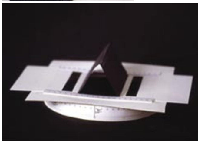
（下圖）厚紙板製成的雙星干涉儀用雙狹縫，可以量測狹縫間距與轉動的角度。
