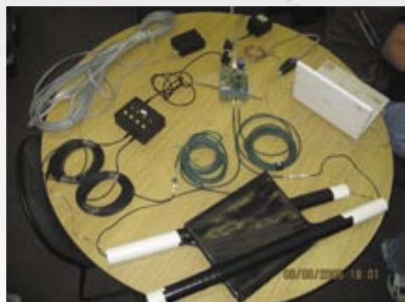
圖四：夸克網宇宙射線探測儀的套件，包括：四片塑膠閃爍器、四支光電倍增管及電源線、訊號線各四條、高壓電源供應器及電源線一條、數據擷取卡及電腦連接線一條和電源變壓器一個、GPS套件及連接線一條（筆記型電腦是自備的，也可以使用桌上型電腦）。
