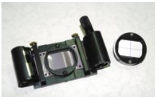
圖2.左為底片必須放進特殊的片匣, 使底片拱成弧形, 以符合施密特相機彎曲之像面。圖右是Single Chip Film holder, 塞上畫十字線的紙片, 方便赤道儀自動導入設定時將亮星放到中央。
