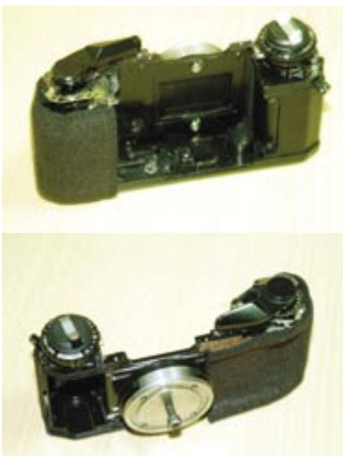
(上)圖4-1. 以二手機背自製施密特相機所用可捲片之片匣正面。
