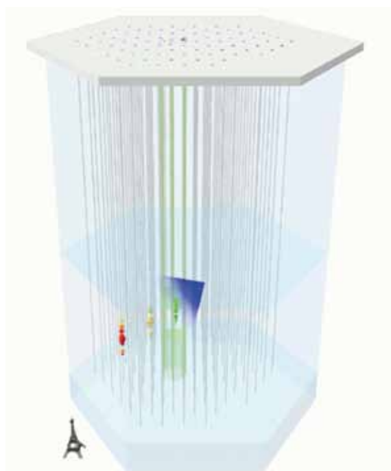
圖4：IceCube實驗[11]由86串偵測器，埋在冰下2000~2400公尺深。左下方為330公尺高的艾菲爾鐵塔，以相同比例放在IceCube旁邊做對比。渺子微中子與冰反應產生渺子，從圖左方進入IceCube。圖中藍色錐體為渺子產生的契倫可夫光，左方幾串偵測器的圓點大小代表接收到信號的強度，顏色(由紅橙黃綠…)代表收到信號的時間。由這些訊息可以推算出渺子的能量與方向。
