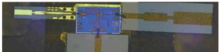
W-頻段次調諧混頻器的顯微放大照片，中央的寶藍色矩形區塊即為積體電路晶片，其尺寸為1500微米長，1000微米寬。
