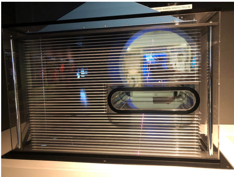
閃光箱中的火花，描繪出宇宙射線走過的路徑，可以將手放在開口處，體驗宇宙射線穿過手的感覺。
