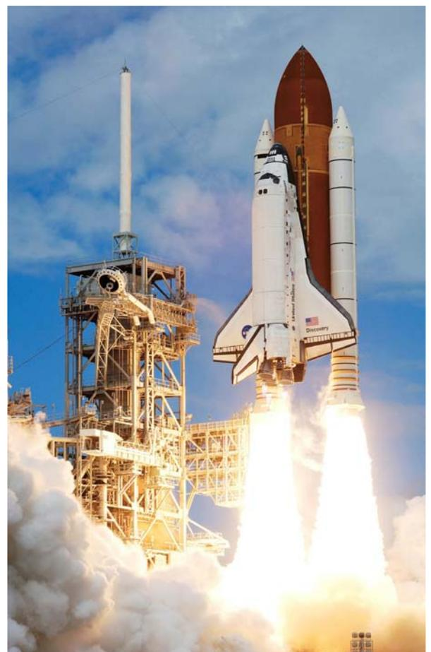
圖7. 火箭起飛時使用大量的水來降噪。圖片來源：NASA
