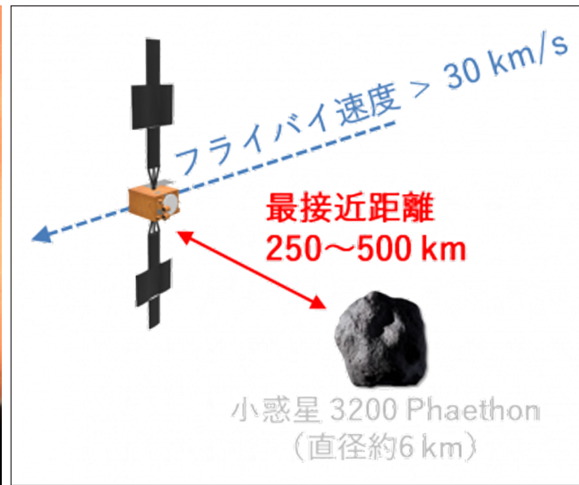
圖6. DESTINY+將以超過秒速30公里的速度飛越法厄同，藉此測試電離推進器與相機高速追蹤拍攝的能力，有助於拓展未來小行星探測的技術。圖片來源：JAXA。
