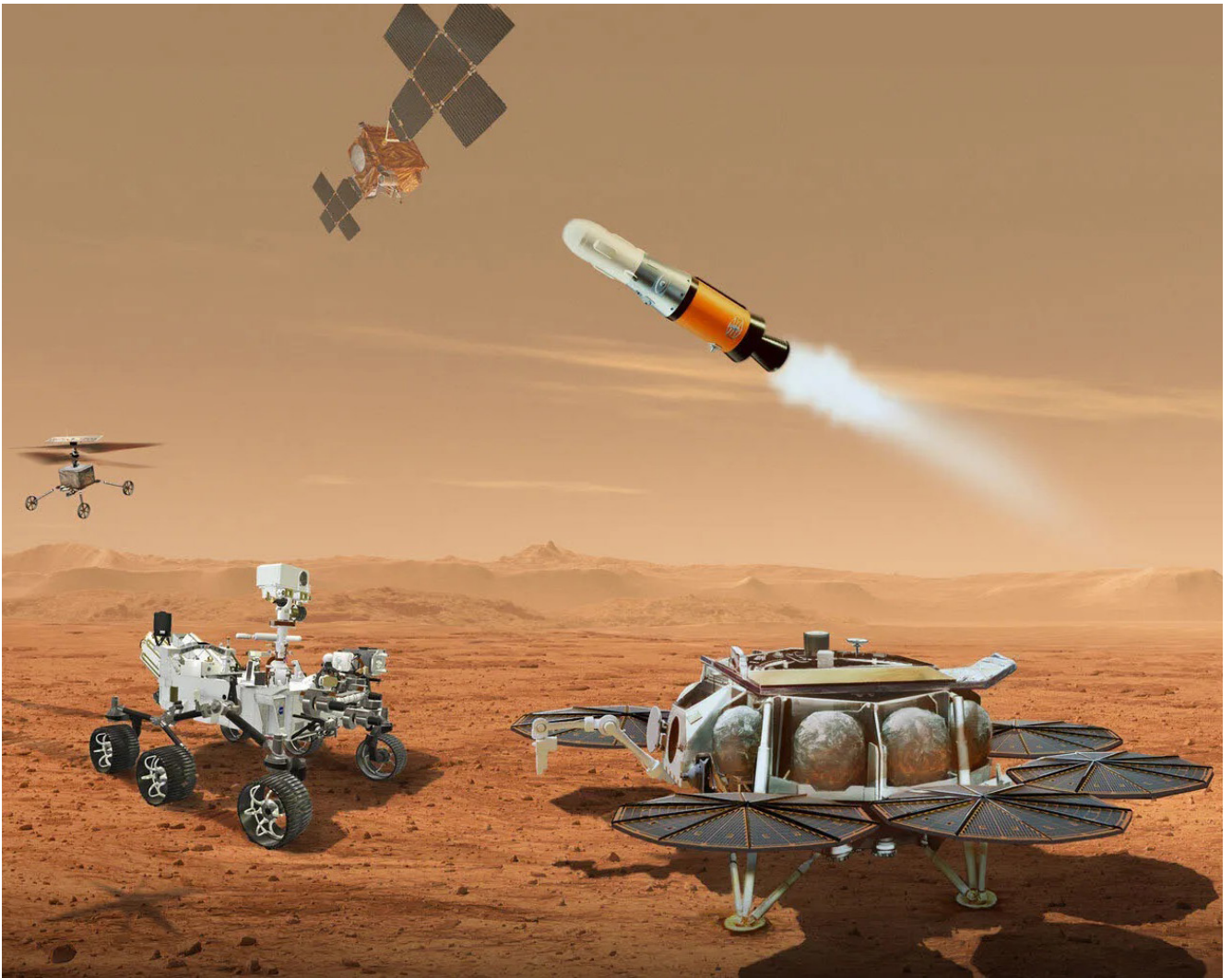
圖5. 火星樣本返回任務將由毅力號 (Perseverance Rover)、樣本取回登陸器 (Sample Retrieval Lander)、火星上升載具 (Mars Ascent Vehicle)、樣本回收直升機 (Sample Recovery Helicopters) 及地球返回軌道器 (Earth Return Orbiter) 共同合作，完成首次從火星帶回樣本的歷史性任務。圖片來源：NASA
