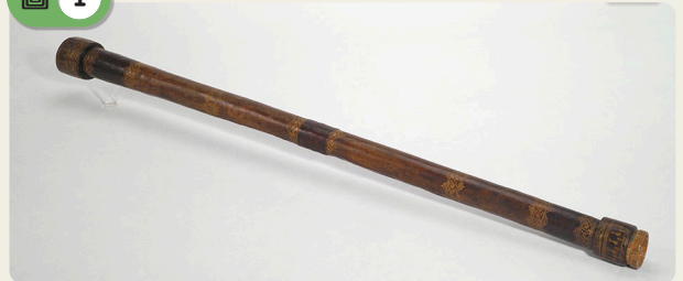
伽利略當時所使用的望遠鏡現藏於義大利佛羅倫斯的伽利略博物館內，圖中為該博物館收藏的其中一支望遠鏡，鏡筒長927mm、口徑僅約15mm。圖片來源：Museo Galileo
