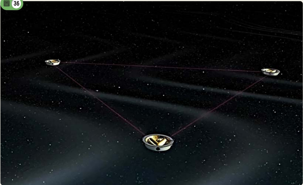
LISA由三座相距數百萬英里的太空雷射干涉儀組成，位於地球的繞日軌道上，距離地球數千萬英里之處，約為地月距離的100倍。三座干涉儀互相傳遞雷射光並進行干涉合成，以偵測時空扭曲所產生的重力波訊號。為了觀測超過太陽百萬倍質量黑洞的相互繞轉現象，需建構尺度如此龐大的探測器。該任務由歐洲太空總署主導，美國太空總署協助，預定於2030年代中期發射，相關準備工作現正積極進行中。圖片來源：European Gravitational Observatory
