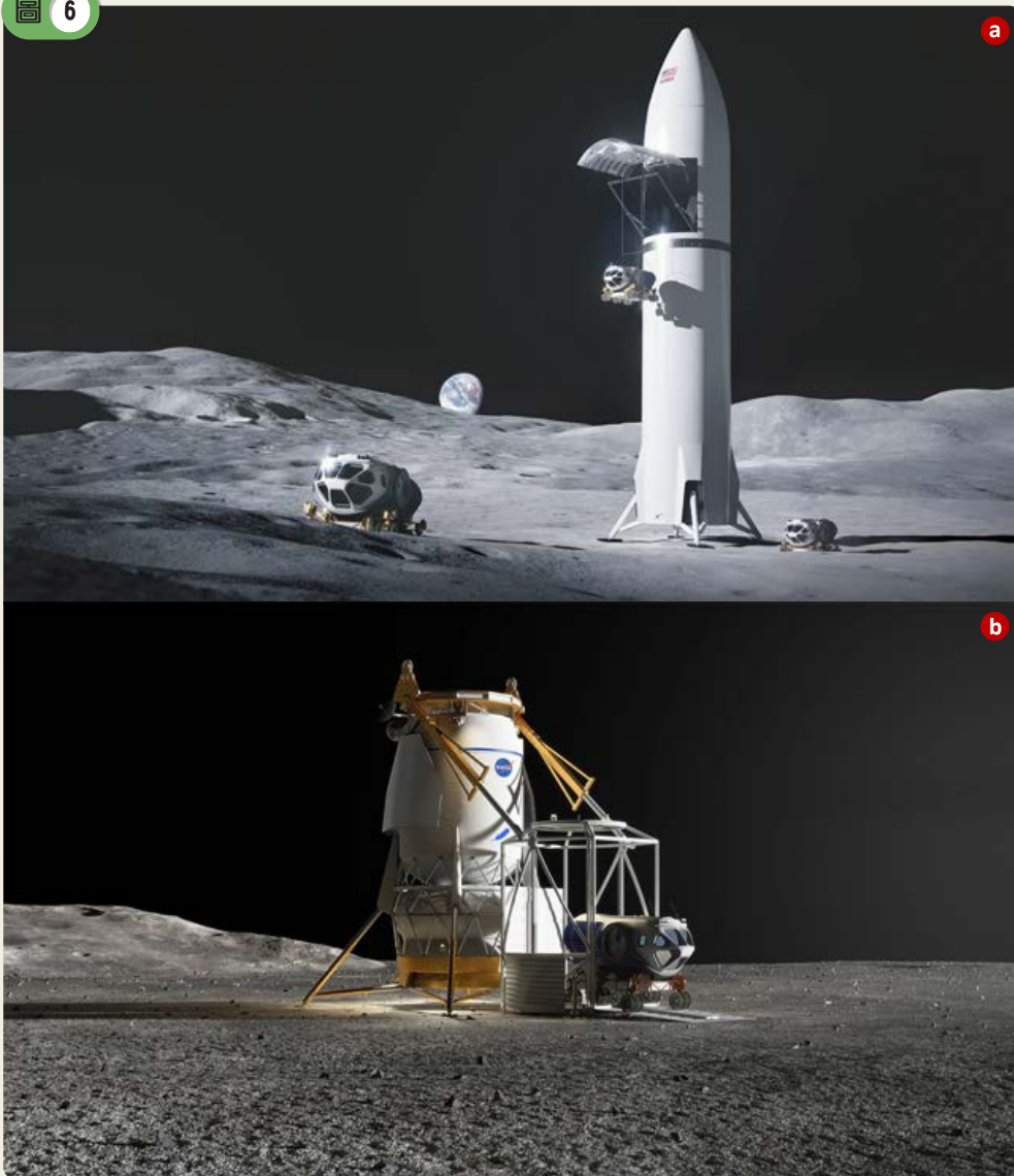
a Space X公司與 b Blue Origin公司提出的人類登月系統概念圖。未來它們可將加壓型月球車、月球基地等基礎設施送上月球表面，每次約能運載15公噸設備。圖片來源：Space X/Blue Origin/NASA
