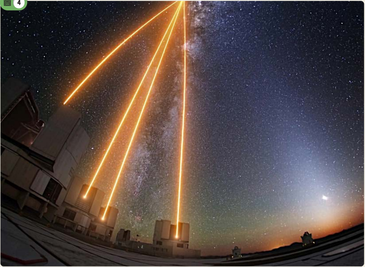
GRAVITY+儀器整合4臺甚大望遠鏡同時用雷射導星的概念圖。圖片來源：ESO
