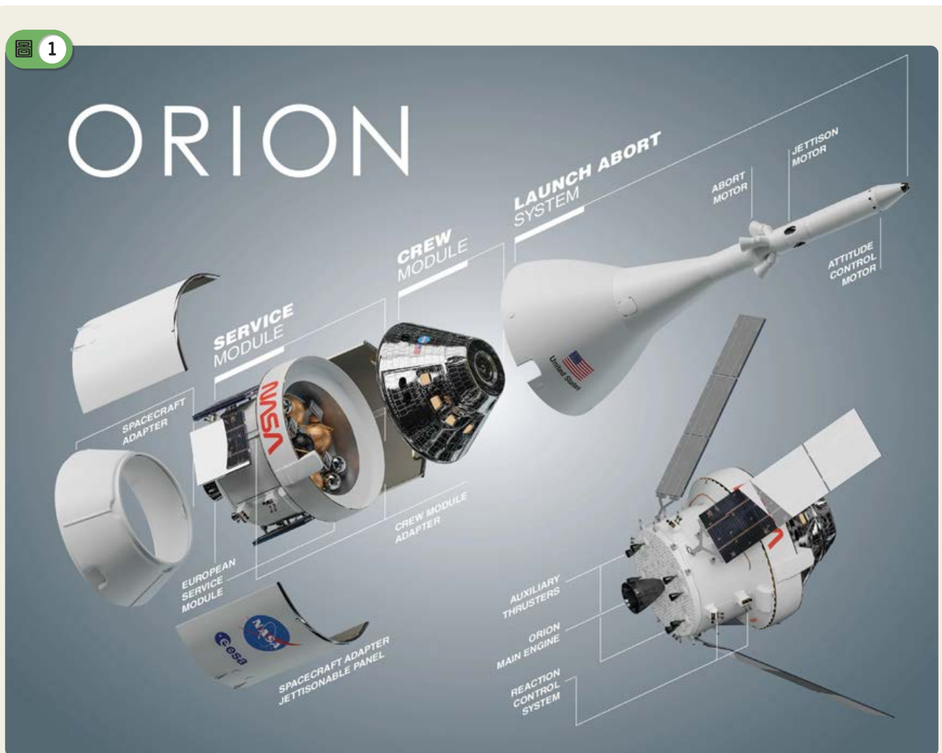
圖 1 獵戶座太空船的主要組成，包括乘員艙、歐洲服務模組、太空船接合器，以及發射逃逸系統。圖片來源：NASA
