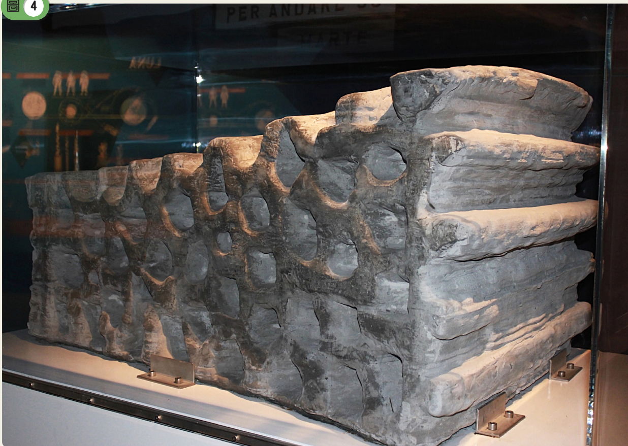
歐洲太空總署利用3D列印技術和月壤製作的建築結構。影像來源：ESA
