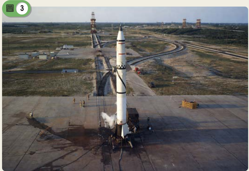
圖 3 1950年代同樣是美、蘇兩國進行軍備競賽的初期階段，此時美國成功研發出中程戰略彈道飛彈「紅石飛彈」，也採用了海達因與其他液態燃料的混合推進劑。影像來源：維基百科
