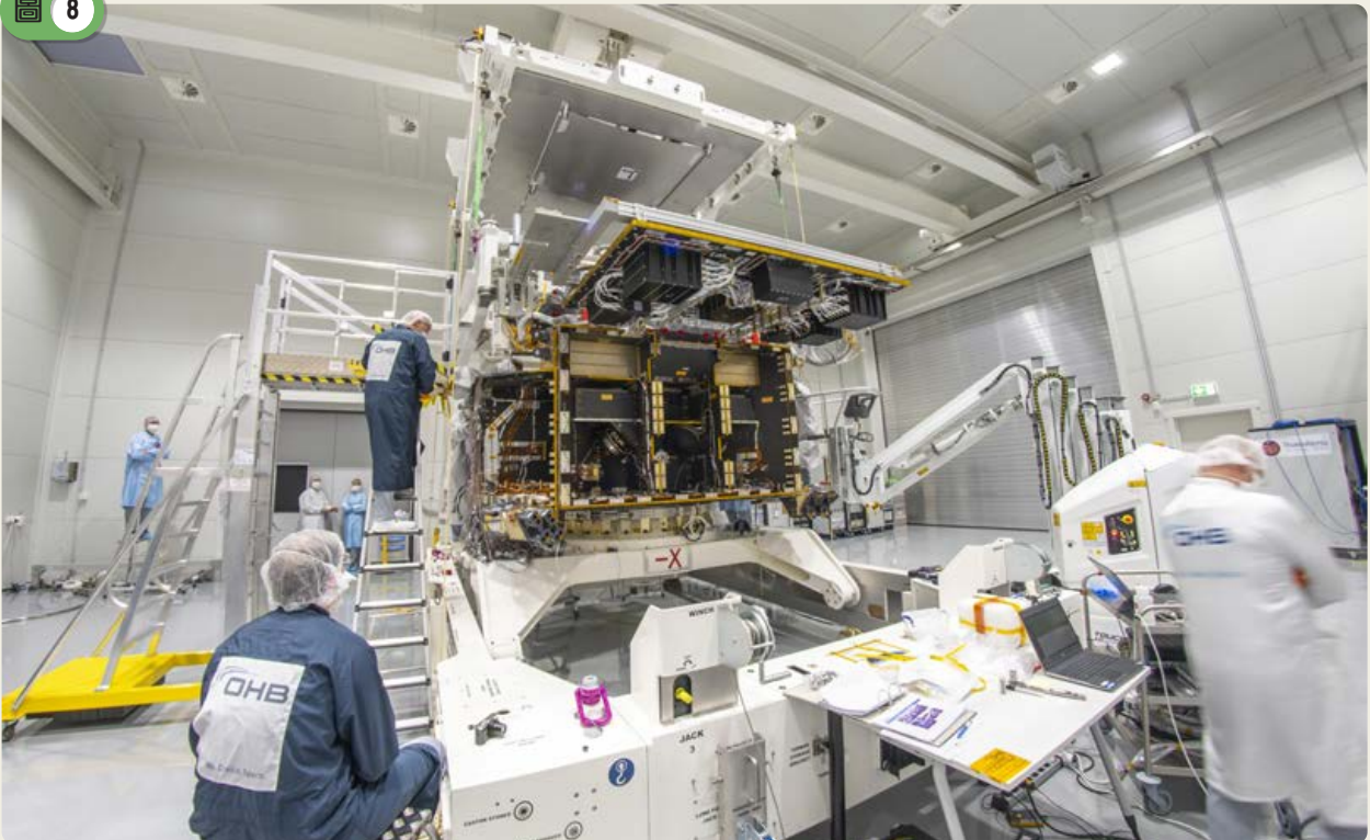
工程團隊正在整合柏拉圖任務太空探測器的兩大核心模組。先使用專用起重設備，把搭載26臺超高靈敏度相機的組件吊升至空中，在精確對準下方的服務模組之後，再將相機組件緩慢降下並完成接合。接下來，探測器將進行多項關鍵驗證測試，確認能夠在模擬太空的環境中穩定運作後，探測器將被運送至位於法屬圭亞那的火箭發射場。該任務預定於2026年12月，由亞利安6型火箭搭載發射升空。影像來源：ESA
